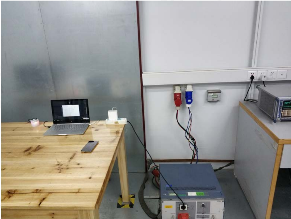
EN 61000-4-2 ESD TEST SETUP
