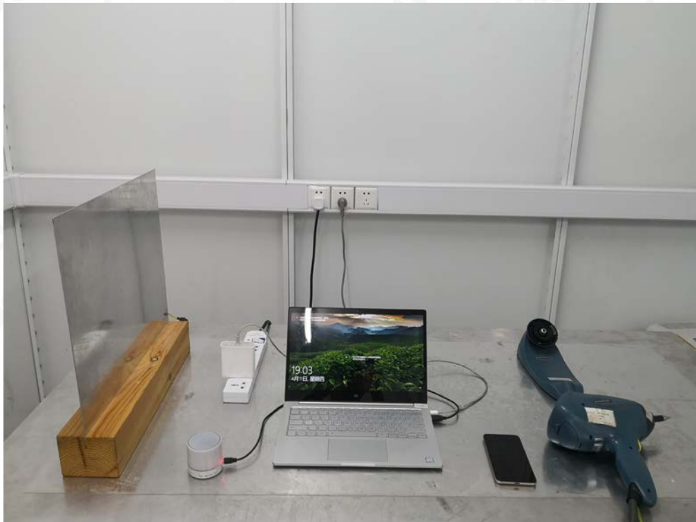
EN 61000-4-2 ESD TEST SETUP
