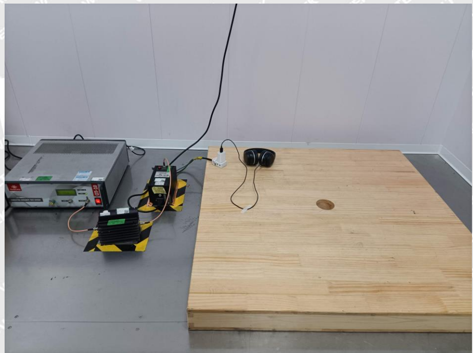
EN 61000-4-6 Test View
