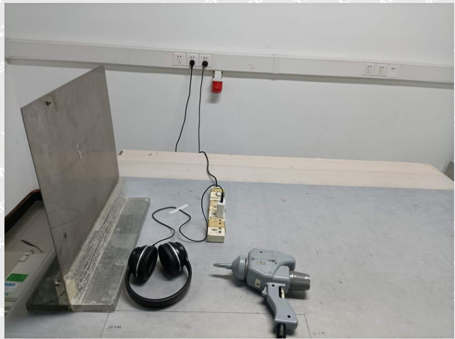
EN 61000-4-2 Test View
