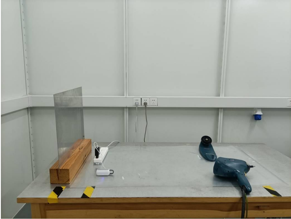
EN 61000-4-3 RS TEST SETUP (Below 1GHz)
