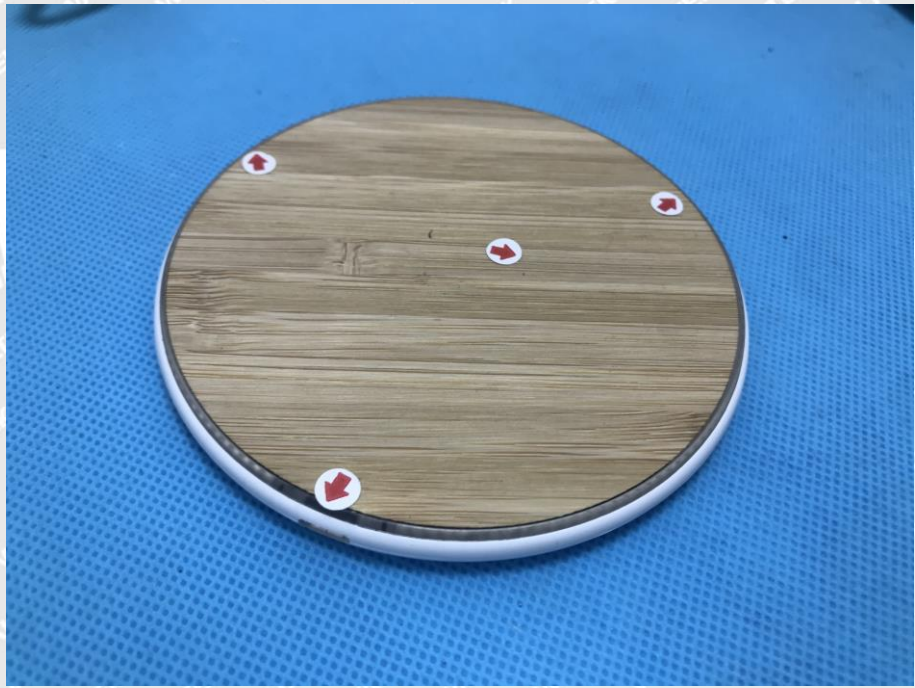
EN 61000-4-2 Test View
