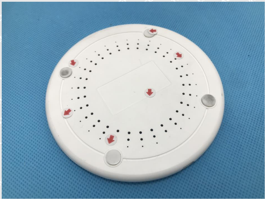
EN 61000-4-2 Test View
