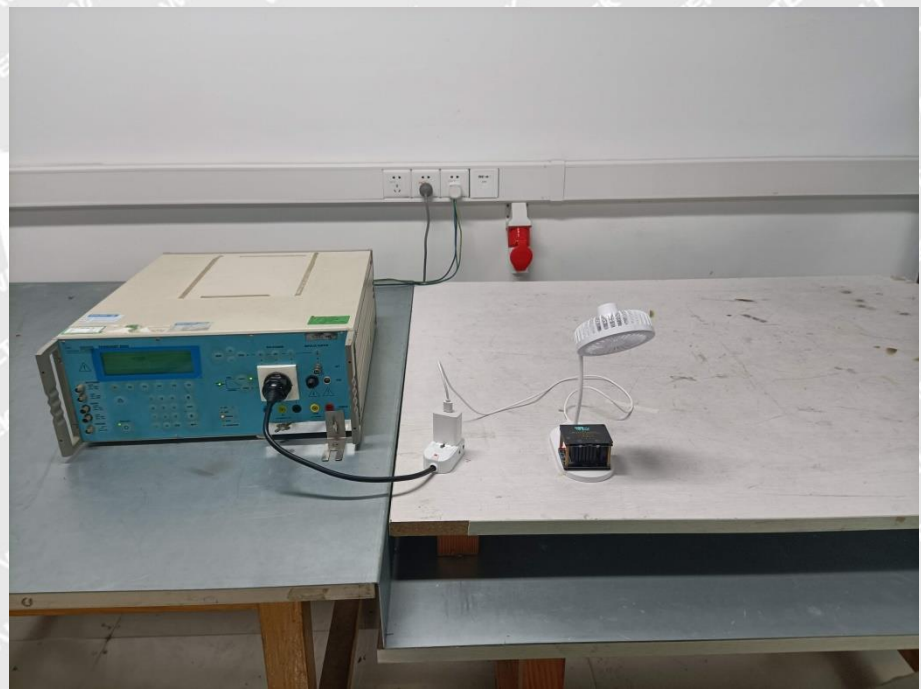
EN 61000-4-4/5/11 Test View
