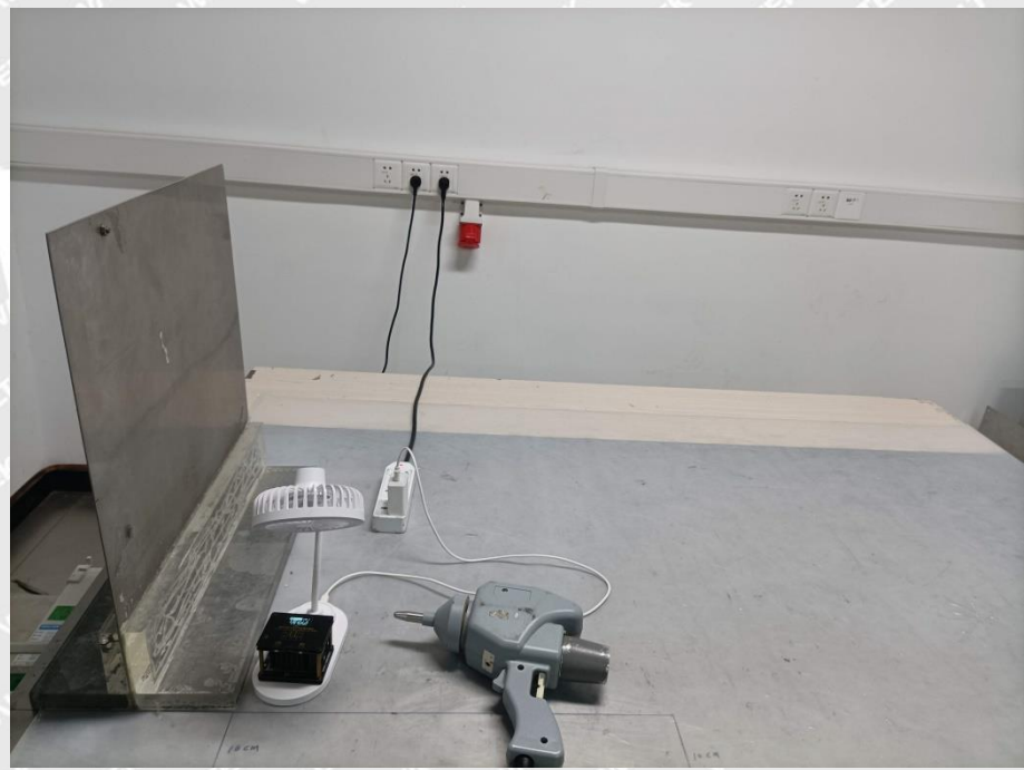
EN 61000-4-2 Test View
